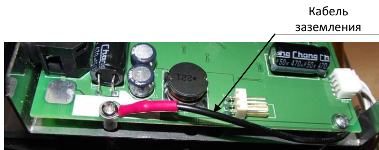
Рисунок 21. Кабель заземления ножа
